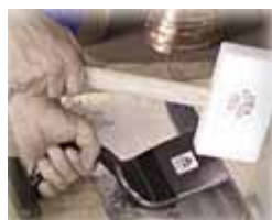
Zaginadło dachowe i młotek teflonowy
